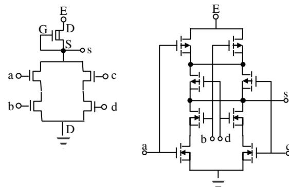
Le circuit CMOS est formé de 4 blocs A<sub>1</sub>, A<sub>2</sub>, B<sub>1</sub> et B<sub>2</sub>. Au-dessous de s, les blocs A<sub>k</sub>, k = 1 ou 2, sont parallèles, chacun est constitué de 2 MOS en série ouverts au repos et au-dessus de s, les blocs B<sub>k</sub> sont en série, chacun est constitué de 2 MOS en parallèle fermés au repos. Le bloc B<sub>k</sub> est le complément du bloc A<sub>k</sub> c.à.d. si l'un est passant l'autre est bloqué. Ainsi
