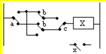
Désignons par  $b_s$  la sortie supérieure du contact b et par  $b_i$  sa sortie inférieure. Le circuit montre que  $b_s = ab + \bar{a}\bar{b} = a \oplus b$  et  $b_i = \bar{a}\bar{b} + ab = a \otimes b$ .
