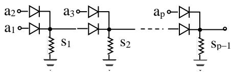
Si  $a_1 = a_2 = \dots = a_p = 0$ , toutes les diodes du circuit ci-dessus se bloquent, aucun courant ne peut traverser le circuit et la tension à la sortie  $s_{p-1}$  sera  $0V < 2.5V$  de valeur logique 0. Mais si  $a_1 = 1$  ( $5V$ ), toutes les diodes inférieures seront passantes d'où les tensions en  $s_1, s_2, \dots, s_{p-1}$
