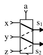
D'après le symbole d'une cellule à 6 orifices, les équations de ses sorties sont :
