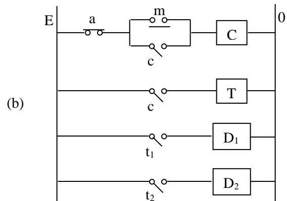
$d_1$  et  $d_2$  sont des pôles principaux respectivement des contacteurs  $D_1$  et  $D_2$ . Les  $c_p$  sont des pôles principaux du contacteur C et les autres pôles c sont auxiliaires.
