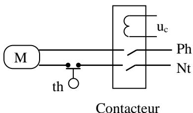
Le contacteur assure par l'induction de la bobine l'isolation galvanique entre l'organe de
