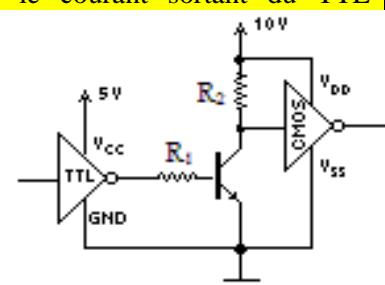
À la sortie du TTL la tension est inférieure à 5V et le courant  $i_s$  doit être inférieur à 2mA. D'où
