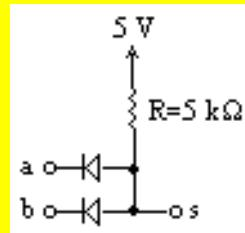
Convenons que le bit 1 correspond à une tension supérieure à 2.5 V et que le bit 0 correspond à une tension inférieure à 2.5 V et supposons qu'on désire réaliser l'expression a<sub>1</sub>.a<sub>2</sub>....a<sub>p</sub> à l'aide de portes AND à diodes chacune ayant 2 entrées. Quelle est la plus grande valeur de p.
