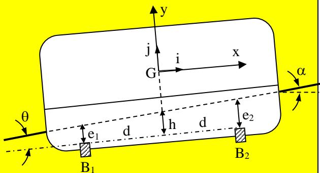
La figure ci-dessus représente un wagon flottant dans l'air au-dessus d'un rail qui fait avec l'horizontal un angle  $\alpha$  et avec le wagon un angle  $\theta$ . Le centre de gravité  $G$  du wagon est équidistant des électroaimants  $B_1$  et  $B_2$  qui sont séparés d'une distance  $2d$  et parcourus par des courants  $i_1$  et  $i_2$ . La masse du véhicule est  $m$  et son moment d'inertie
