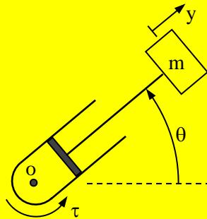
Le bras d'un robot, constitué d'un cylindre de section S muni d'un piston entraînant une masse m,
